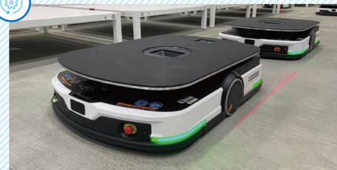
自動搬送車 (AGV) が導入された輸出上屋 / Export Warehouse with AGV installed
