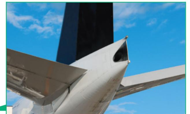
APU(補助動力装置)の排気口
