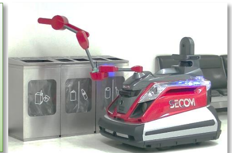
点検用アームによるゴミ箱内の点検
