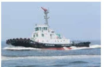
タイヤを防舷材に用いた ダイトーコーポレーション保有船舶 (防災曳船「はくと」)
