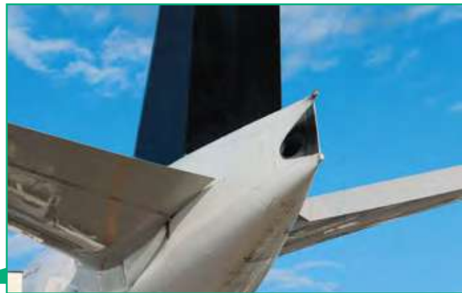
APU(補助動力装置)の排気口
