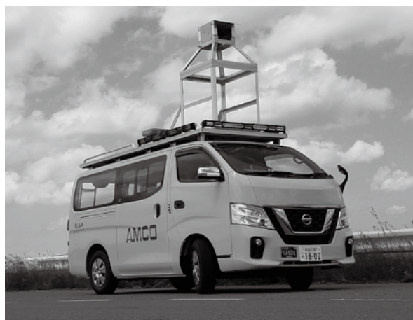
地上3.6mの高さに赤外線カメラを設置した路面点検車
