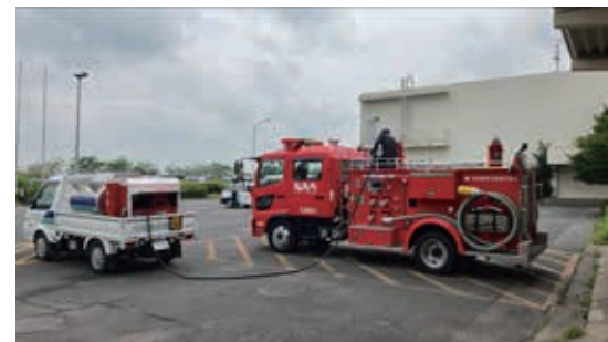
消防車へのRD給油
