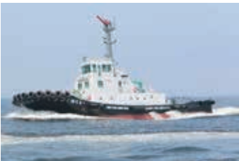
タイヤを防舷材に用いた ダイトーコーポレーション保有船舶 (防災曳船「はくと」)
